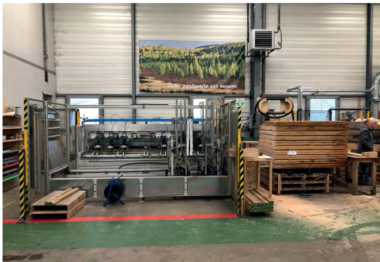
EBS possède une ligne automatisée dédiée à la fabrication de semelles de palettes. SD
