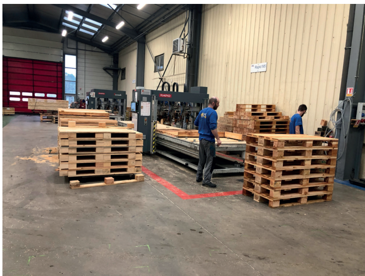
EBS possède une ligne automatisée dédiée à la fabrication de semelles de palettes. SD
